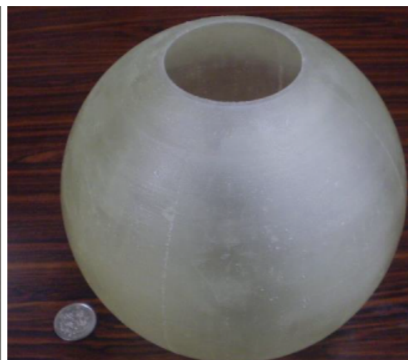
1 2 面体上に配置されたLEDと拡散球
