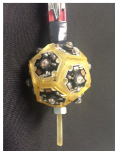
1 2 面体上に配置されたLEDと拡散球
