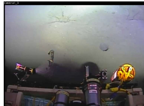
掘削孔 水深1,887m の海底に 深度19mの観測 孔を掘削
