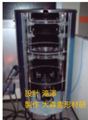
EUSO-SPB2 1m 非球面レンズ 設計 米国 (滝澤参加) 製作 滝澤
