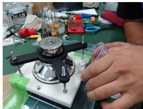
光学ゲルで作られた パッドの試験製作
