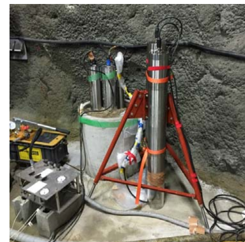
2015年度に実施した孔内ジオフォン・加速度計モジュール評価試験
