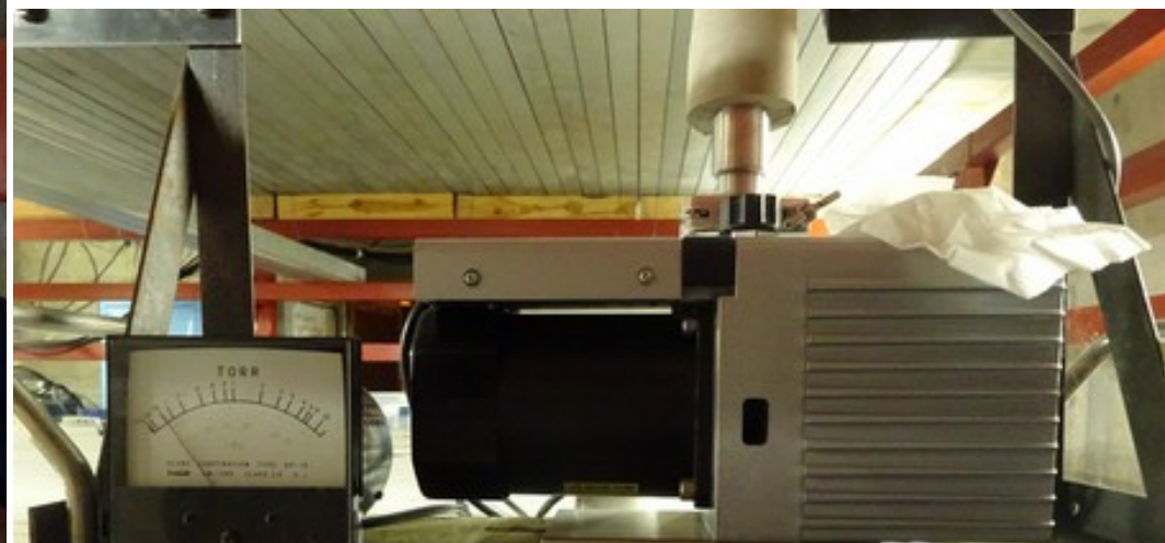
真空系と真空ポンプ(能力: 5.6 \times 10^{-2} Pa)
