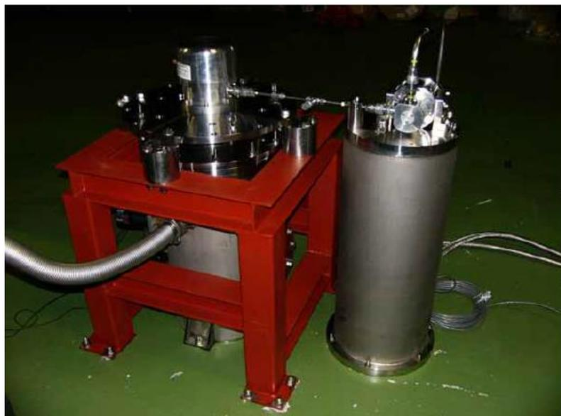
LCGTの低温技術実証用プロトタイプCLIOのために、パルス管ベースの低振動冷凍機システムを住重と共同開発した。実効コールドヘッドでの振動を、ベースとなったパルス管冷凍機の約1/1000に低減した
