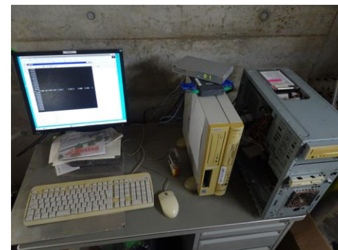
明野ミュオン観測のデータ収集回路とPC
