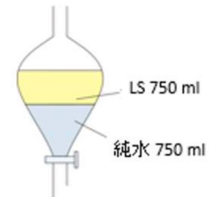
図 5.11 分液漏斗模式図
