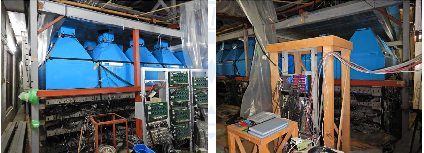
徹底した省電力化により消費電力65Wで運転していた。(含むDAQ用PC)
